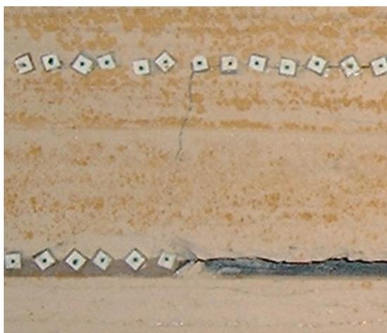
Рис. 3 – Распространение трещины в слое кровли перед обрушением
