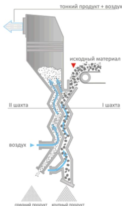
Рис. 2 – Технологическая схема классифицирующего комплекса КГ
