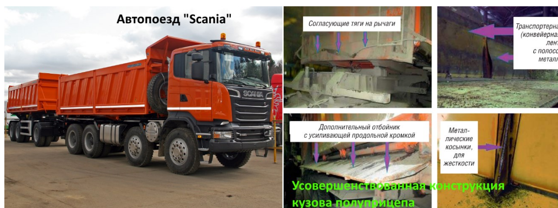
Рис. 3 – Автосамосвал «Scania», разработанный для АО «Алроса» [4]
