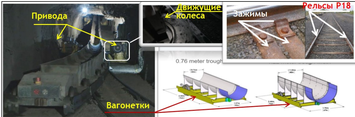
Рис. 5 – Общий вид транспортной системы «Rail-veyor» [6]
