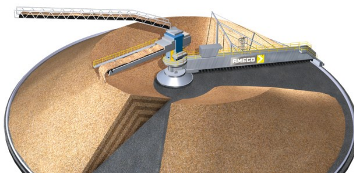
Рис. 4 – Схема формирования а – продольного и б – кругового усреднительного склада шевронного типа
