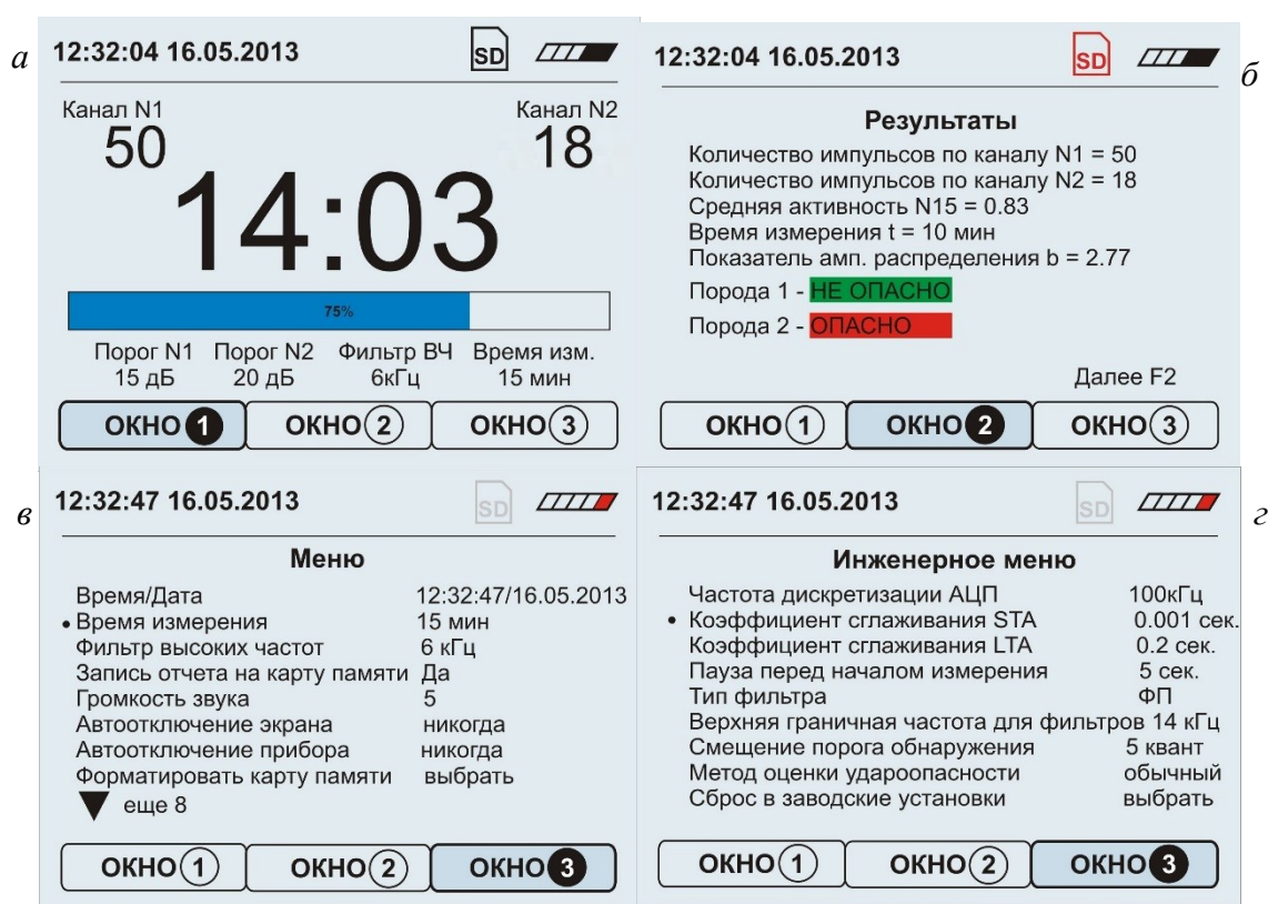
Рис. 2 – Главное окно (а), отражающее процесс измерения, окно представления результатов АЭ контроля (б), пользовательское (в) и инженерное (г) меню для настройки прибора «Prognoz L»
