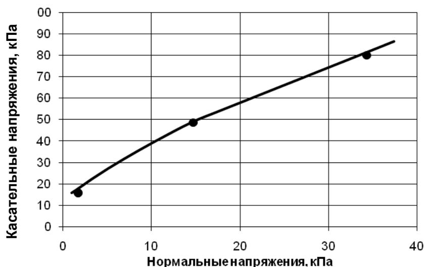
Рис. 5 – Паспорт прочности при сдвиге гранита по трещине
