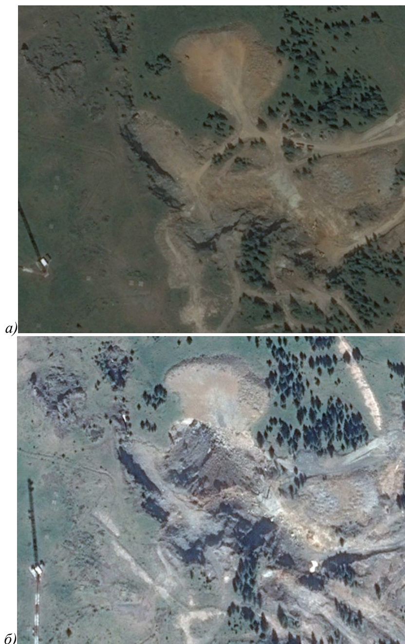
Рис. 1 – Обрушение поверхности карьера в Южной части месторождения в июле 2013 г.: а) - снимок Google от 05.07.2013; б) - снимок Google от 01.06.2016
