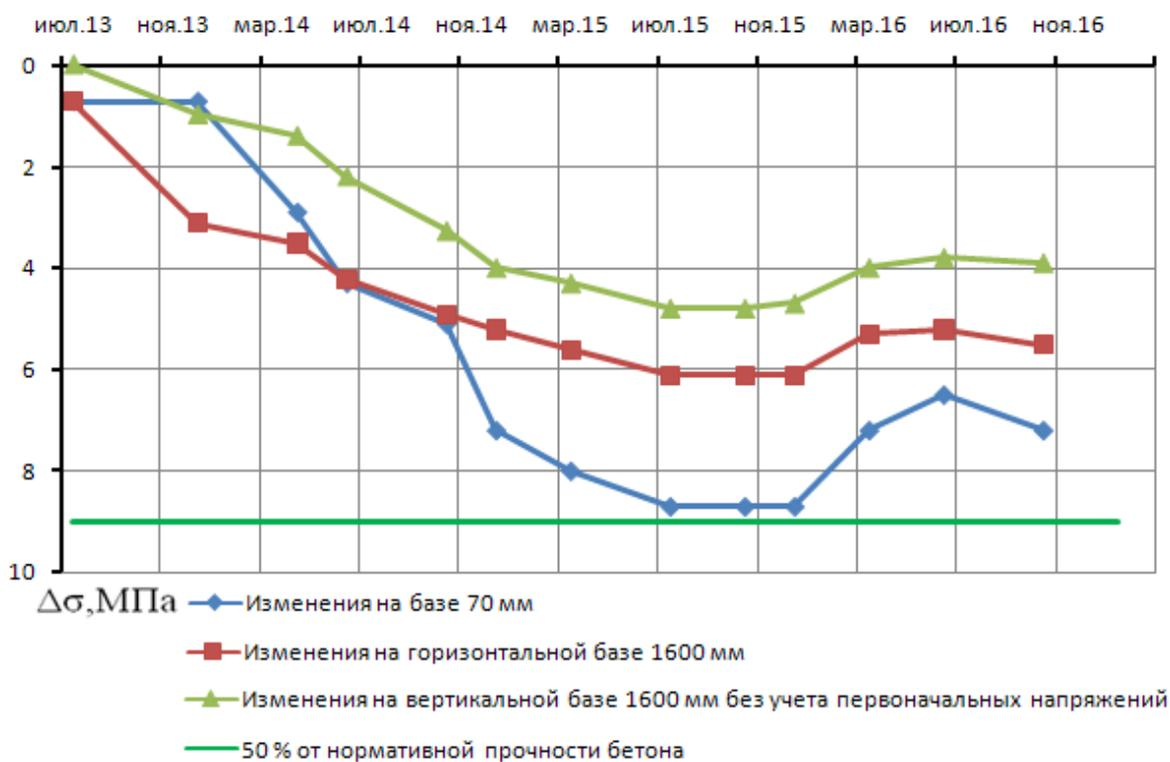
Рис. 3 – График изменения напряжений в бетонной крепи ствола шахты «Клетевая» на горизонте -990 м
