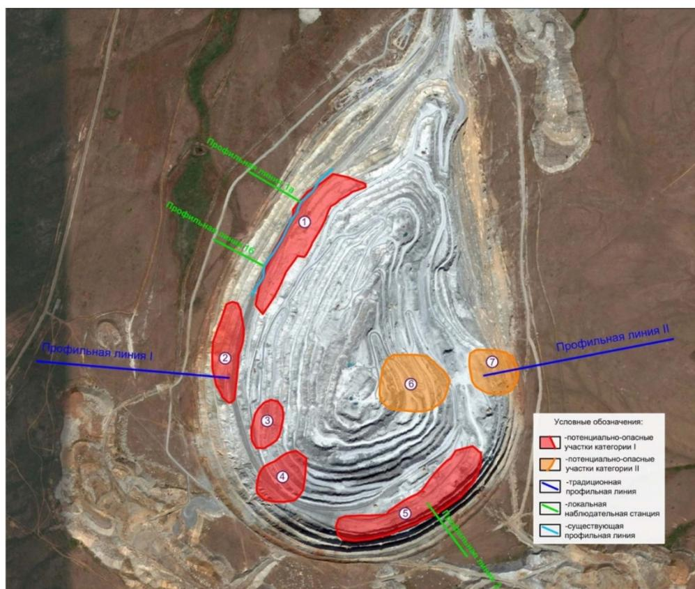
Рис. 5 – Схема наблюдательной станции Киембаевского карьера
