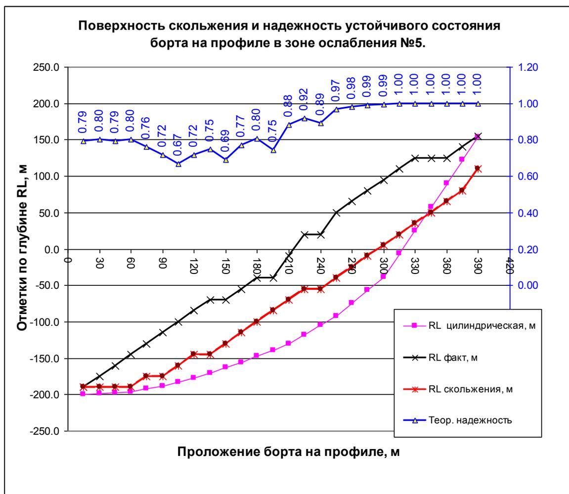
Рис. 1 – Результаты построения поверхности скольжения и оценки надежности устойчивого состояния борта карьера (ось справа) в зоне № 5 на модели ВМПР
