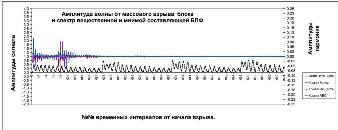
Рис. 3 – Сигнал и спектр от взрыва блока при направлении 45 градусов
