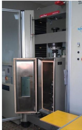
Рис. 1 – Испытательная машина UTS 250 с температурной камерой
