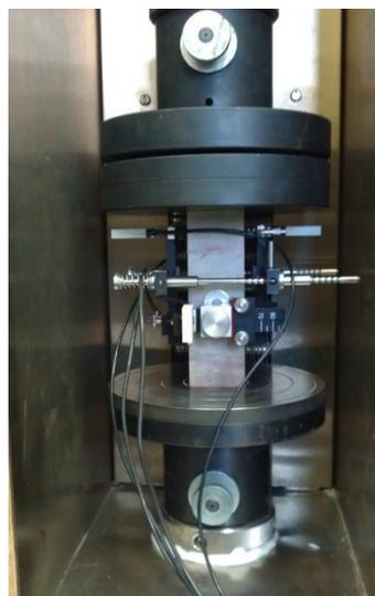
Рис. 2 – Образец в температурной камере
