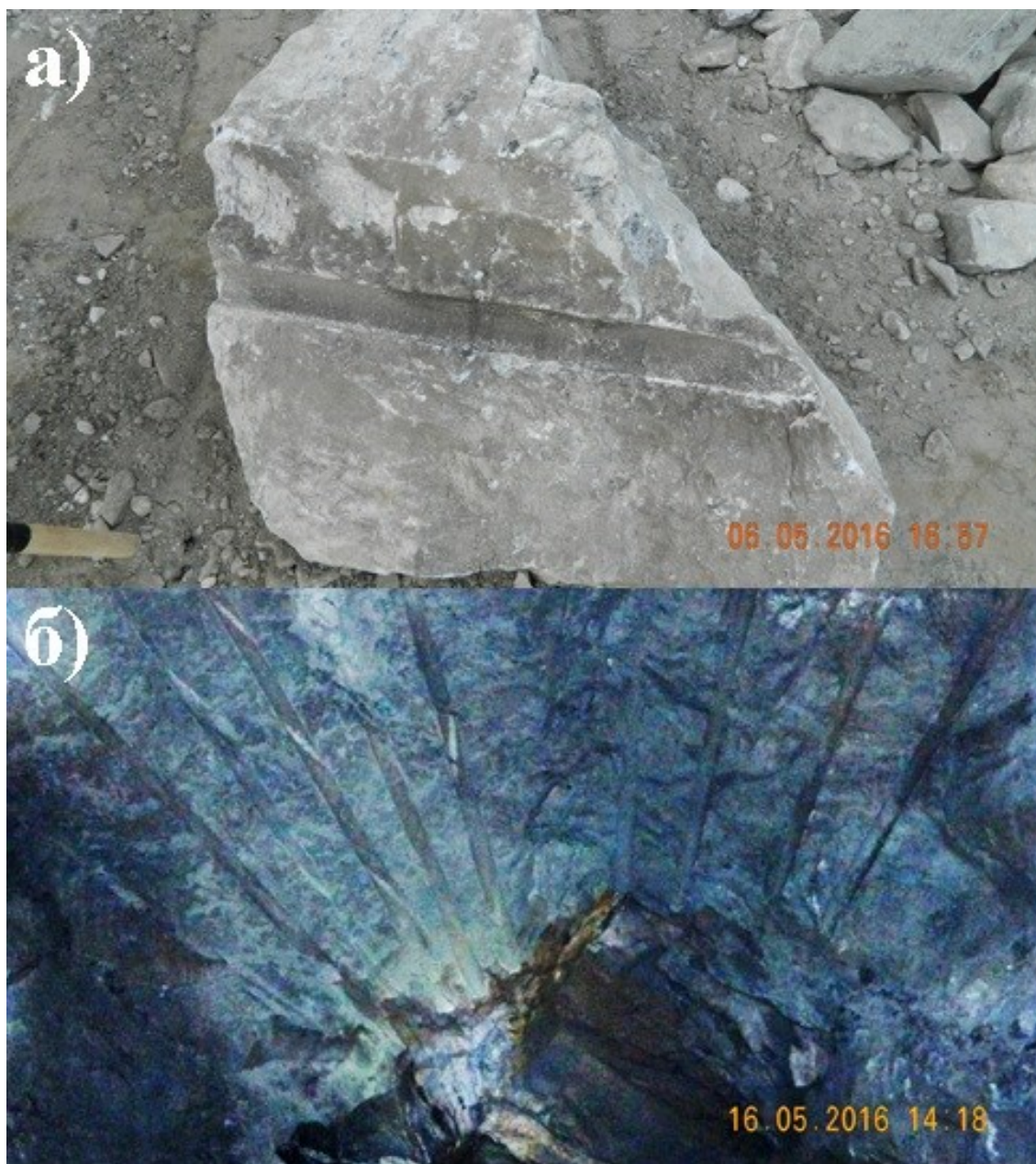
Рис.4 – Откол слоя по плоскости расположения скважин: а) на поверхности; б) в камере
