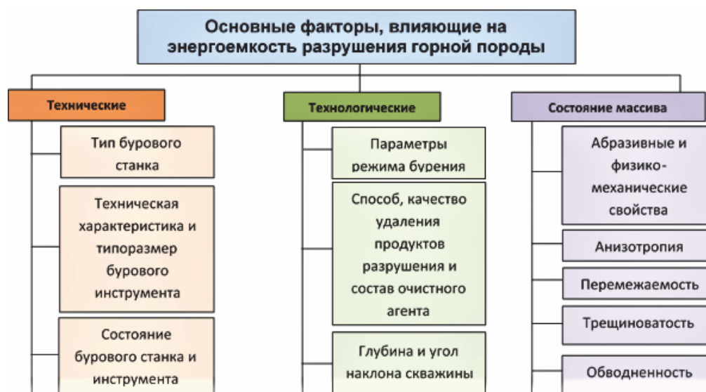
Рис.1 – Основные факторы, влияющие на энергоемкость разрушения горных пород при шарошечном бурении взрывных скважин
