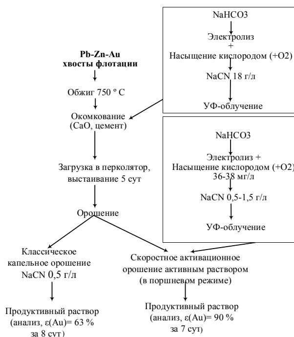
Рис. 5 – Схема выщелачивания хвостов флотации после обжига и окомкования с применением капельного орошения и активационного скоростного выщелачивания
