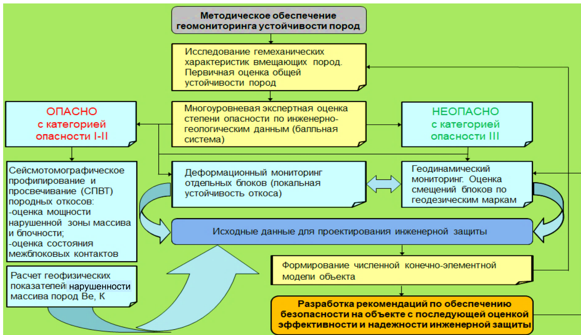
Рис. 3 – Блок-схема экспресс-методики геотехнического сопровождения ИЗ в скальных массивах [10] (Мелихов М.В., Абрамов Н.Н., Кабеев Е.В.)
