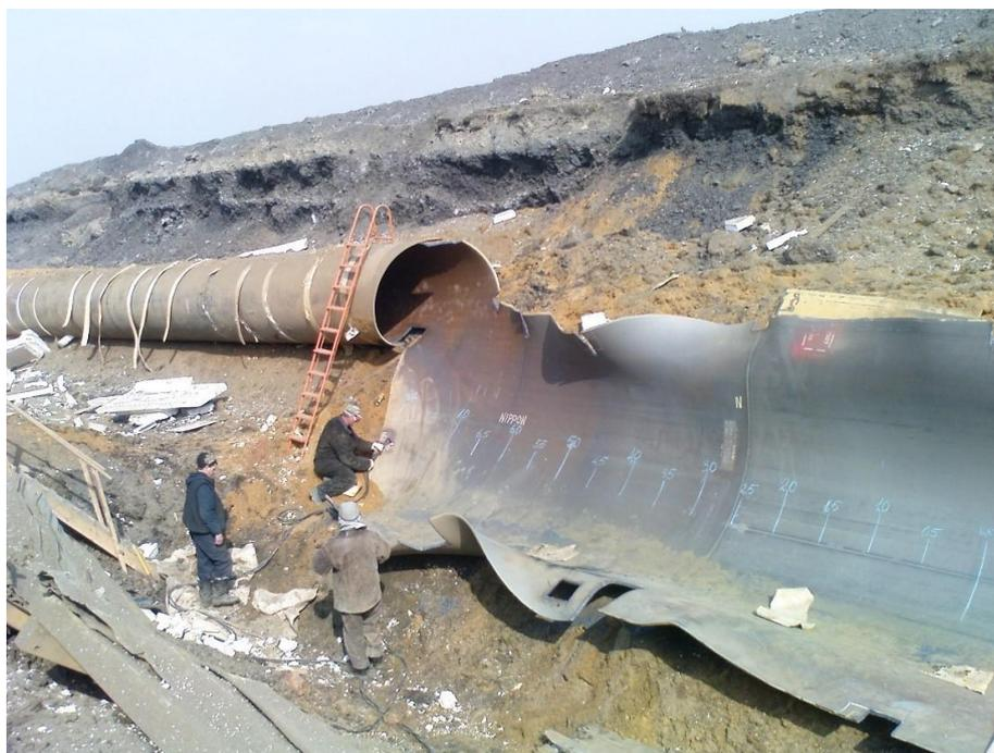
Рис. 12 – Результат подрыва кумулятивного заряда на трубе под давлением
