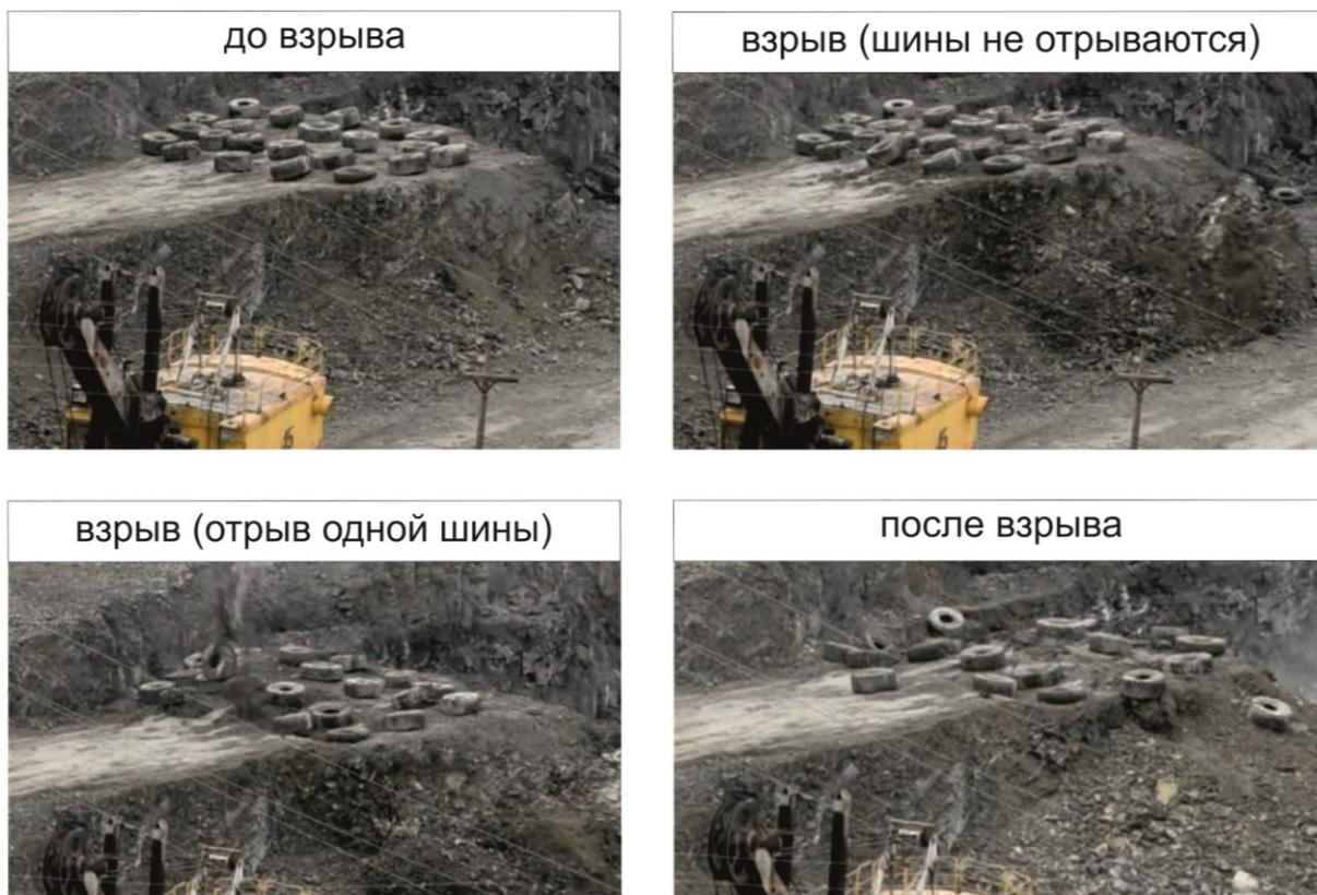
Рис. 10 – Испытание укрытия из шин автосамосвалов при проведении взрывных работ в условиях Карагайского карьера
