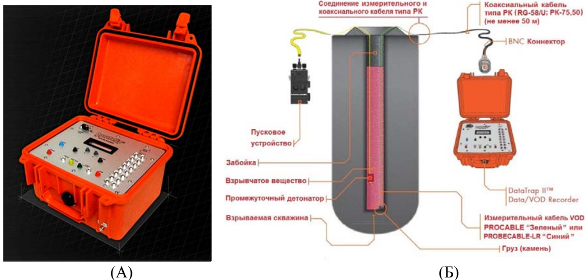
Рис. 1. Прибор DATATRAP II DATA/VOD Recorder (А) и схема измерения скорости детонации ВВ в одной скважине (Б)
