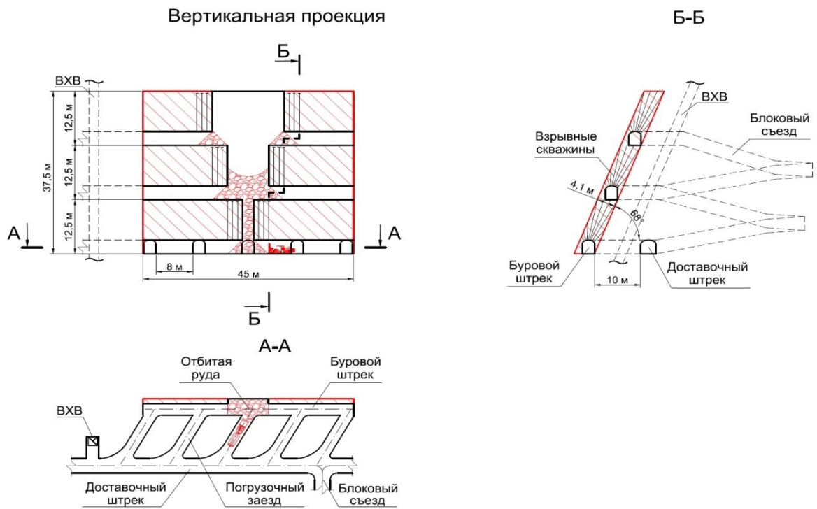
Рис. 1 – Система разработки ПШ (1 вариант)
