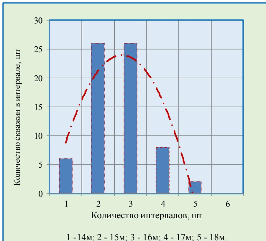
Рис. 1. Тренд варьирования глубины пробуренных скважин, карьер Южный, борт Восточный, гор. 62/47, блок № 197
