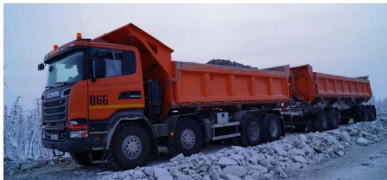
Рис. 5. Автопоезд Scania на транспортировании руды с Верхне-Мунского месторождения АК «Алроса» [14]
