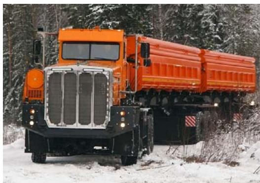
Рис. 4. Многосезонный автопоезд ТОНАР-7502 грузоподъемностью 130 т [12]
