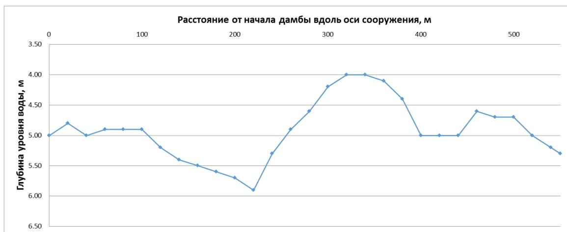
Рис. 3 – Изменение уровня воды вдоль уступа дамбы
