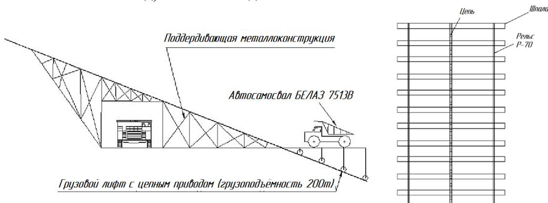
Рис. 8 – Модель подъемной установки с цепным приводом [10]
