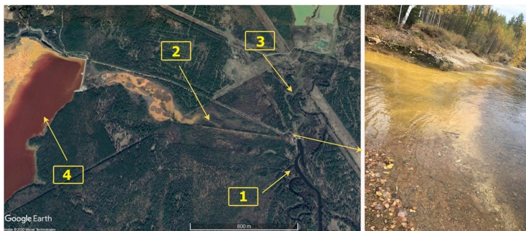
Рис. 4 – Место впадения реки Левиха в реку Тагил 1 – река Тагил до впадения реки Левиха; 2 – сбросной канал (русло реки Левиха); 3 – река Тагил после впадения реки Левиха; 4 – пруд-осветлитель
