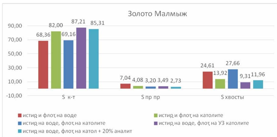
Рис. 5 – Показатели извлечения золота в процессе комбинированной флотации
