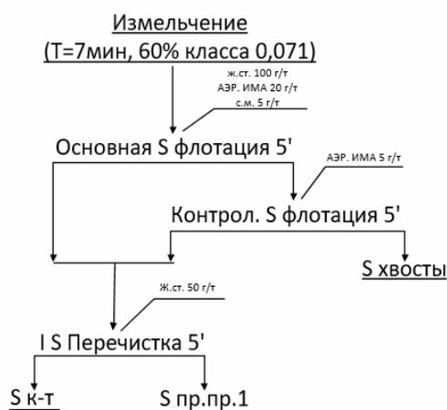
Рис. 1 – Схема коллективной флотации медно-порфиоровой руды
