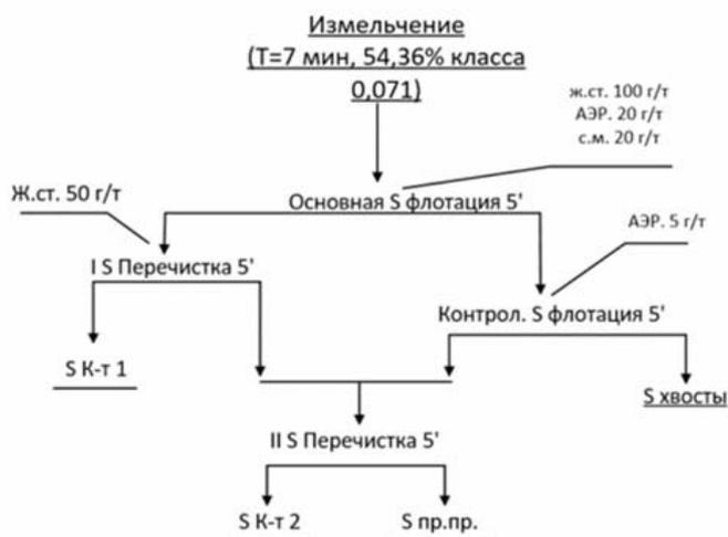
Рис. 2 – Схема и реагентный режим коллективной флотации золотокварцевой руды
