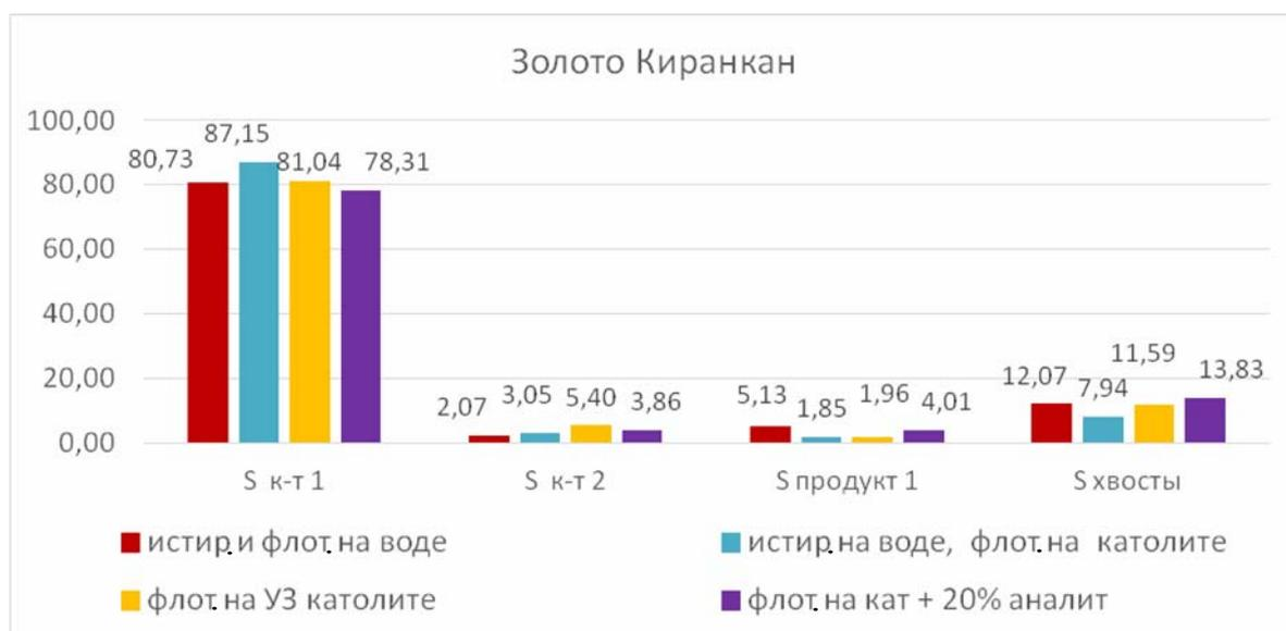
Рис. 6 – Показатели извлечения золота в процессе комбинированной флотации золотокварцевой руды
