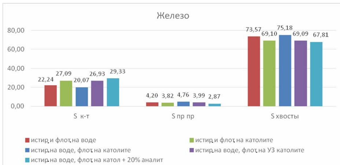
Рис. 4 – Показатели извлечения железа в процессе комбинированной флотации
