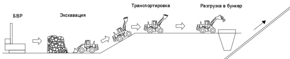
Рис. 1. Технологическая схема работы погрузчиков
