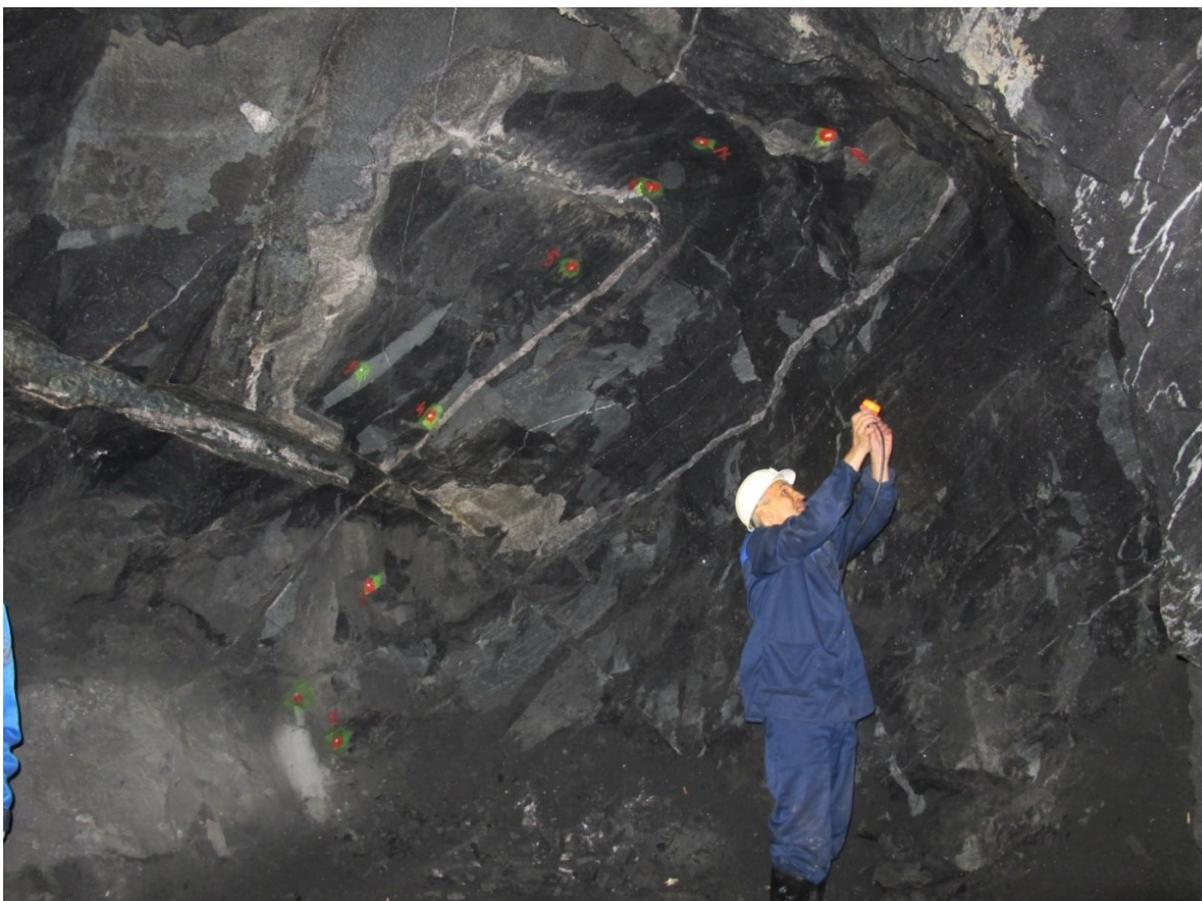
Рис. 1 – Размещение деформационных марок в сечении выработки
