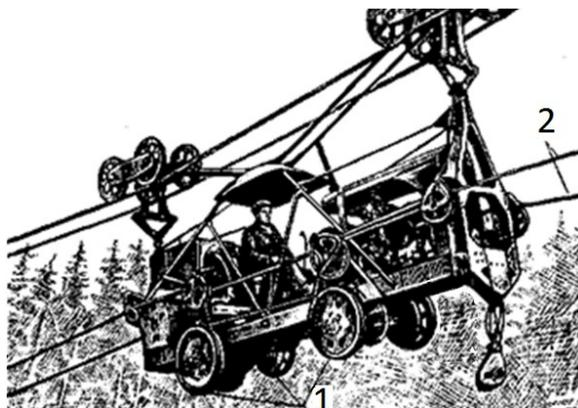
Рис. 3 – Самоходная грузовая тележка кабельного крана
