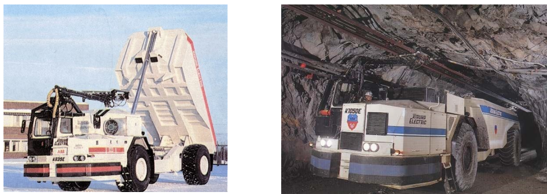
Рис. 6 – Подземный самосвал с электрическим питанием KirunaElectrictruck K635E и K1050E
