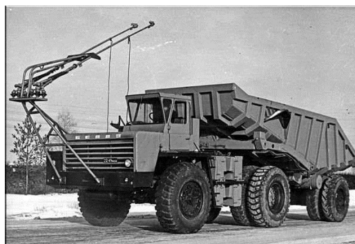
Рис. 4 – Дизель-троллейбусы БелАЗ: слева – 3-D модель дизель-троллейбуса грузоподъемностью 220 – 240 т [13]; справа – дизель-троллейбус БелАЗ-Э524-792 [14]
