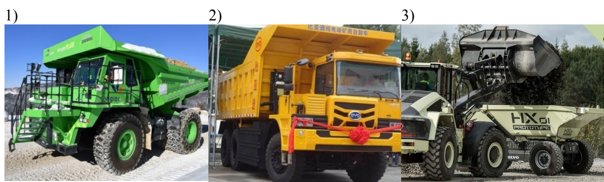
Рис. 1 – Карьерные автосамосвалы с аккумуляторными батареями без дизельных двигателей: 1 – самосвал-электромобиль eDumper (на шасси KOMATSU HD 605-7) [2, 6]; 2 – Китайский самосвал-электромобиль BYD V60 [3, 4]; 3 – роботизированный самосвал Volvo HX1 [5]
