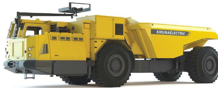
Рис. 7 – Подземный дизель-троллейвоз EMT-50 [30]
