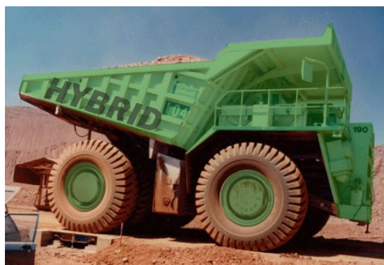
Рис. 3 – Карьерный автосамосвал с гибридной дизель-аккумуляторной электромеханической энергосиловой установкой, созданный на базе карьерного автосамосвала компанией GE [8, 9]
