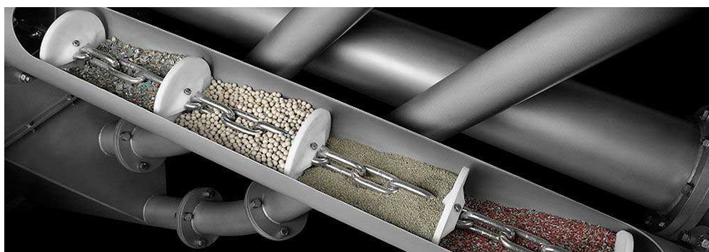
Рис. 8 – Схема селективной транспортировки горных пород в скребковом конвейере
