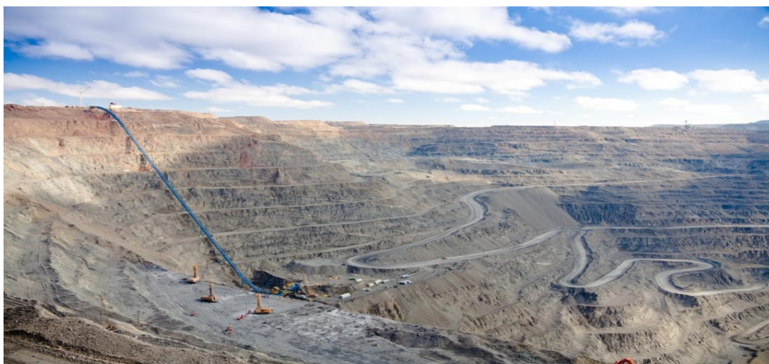
Рис. 1 – Крутонаклонный ленточный конвейер на карьере Мурунтау (Узбекистан)
