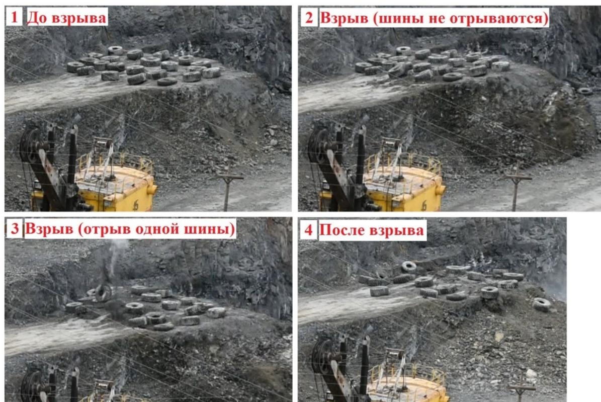
Рис. 5 – Испытание укрытия из шин автосамосвалов при проведении массового взрыва на Карагайском карьере 24 октября 2018 г.
