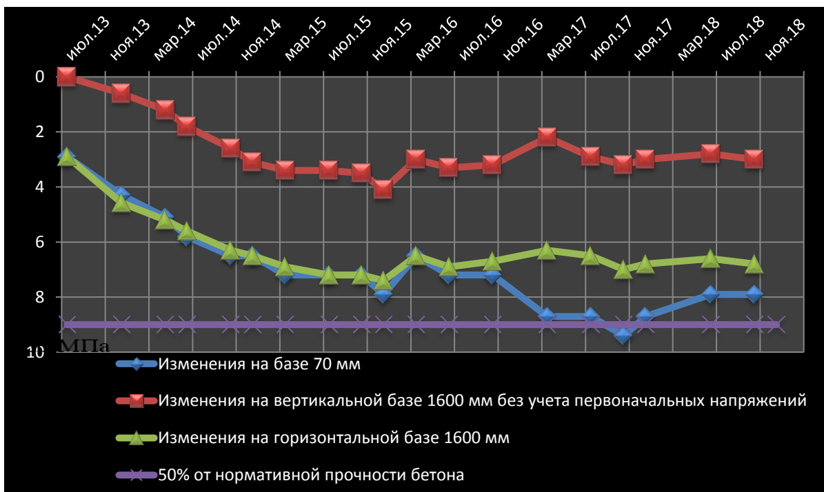
Рис. 2 – График изменения напряжений в бетонной крепи ствола шахты «Клетевая» на гор. -910 м
