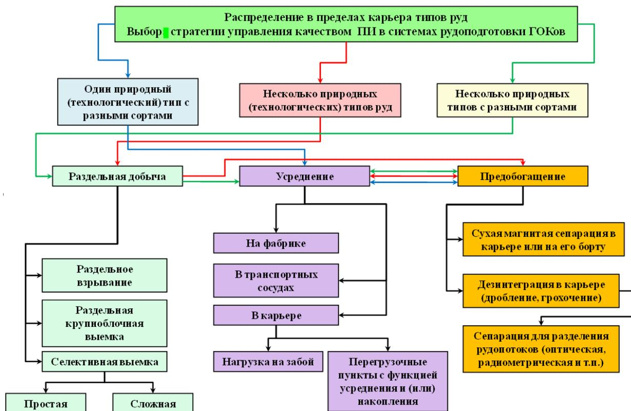
Рис. 1 – Схема выбора методов управления качеством руды
