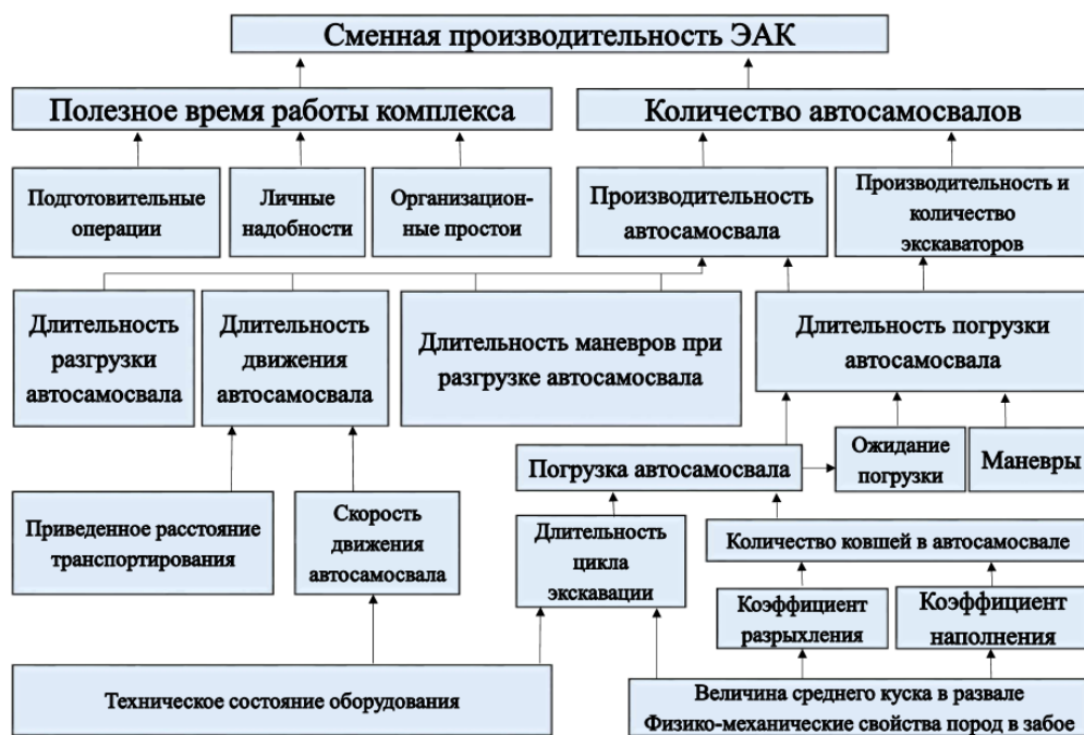
Рис. 3 – Схема формирования сменной производительности ЭАК на основе вероятностных факторов
