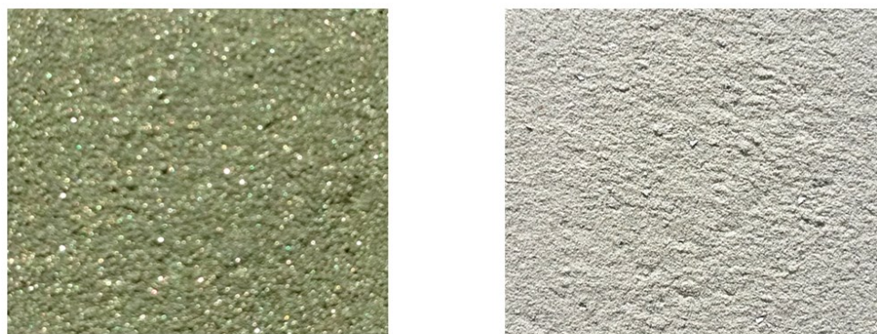
Рис. 5 – Сульфидный концентрат с содержанием 10,77 % Cu и хвосты коллективной флотации с содержанием 0,02 % Cu
