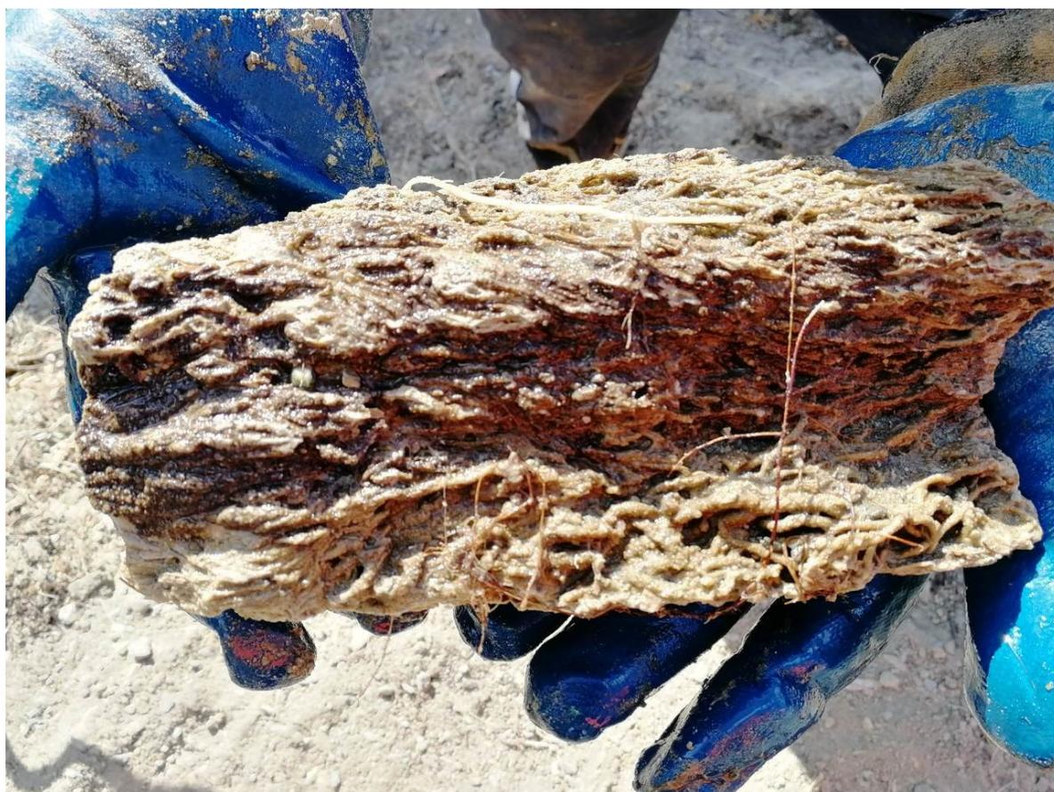
Рис. 2 – Фрагмент органо-минерального материала, из которого состоит засор трубчатого дренажа
