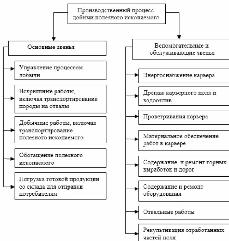
Рис. 1. Схема производственного процесса добычи полезного ископаемого
