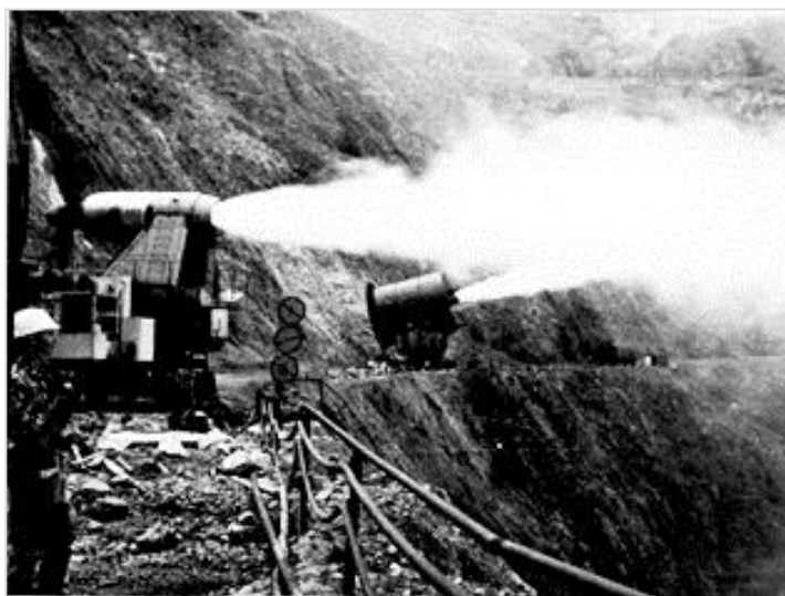
Активное воздействие воздушно-газожидкостных струй на пылегазовое облако с помощью турбовентилятора-оросителя НК-12КВ-1М
