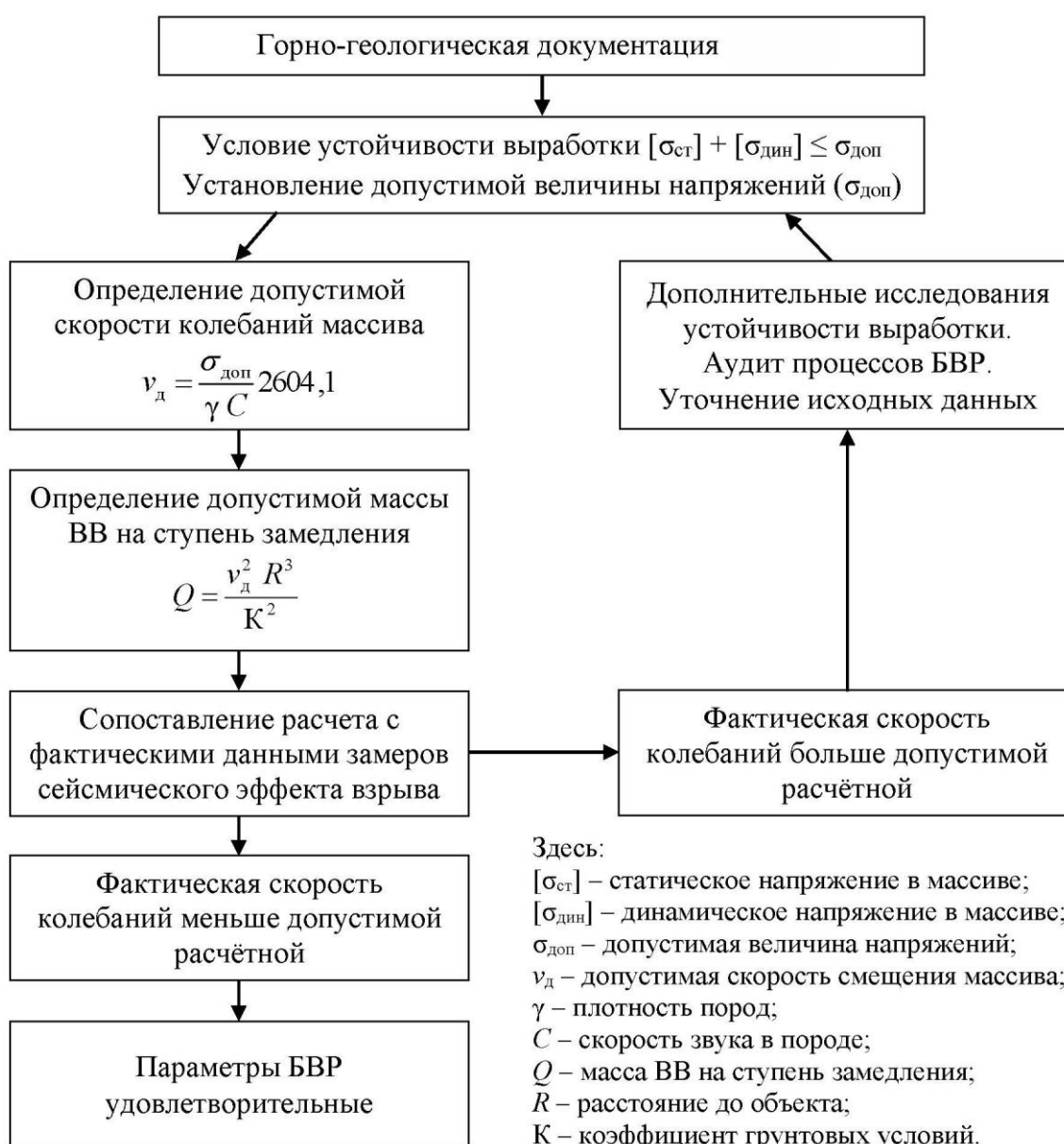
Рис. 1. Методика исследований сейсмического действия взрыва
