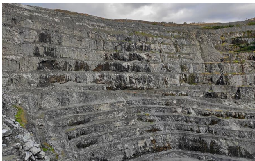
Рис. 1. Участки бортов карьера АО «Ковдорский ГОК», поставленные в конечное положение с использованием ЗКВ-Б
