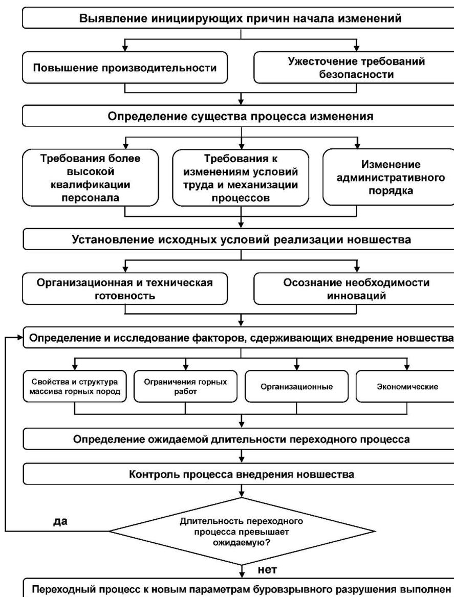
Рис. 1. Общий порядок организации переходного процесса при адаптации технологических процессов БВР к меняющимся условиям
