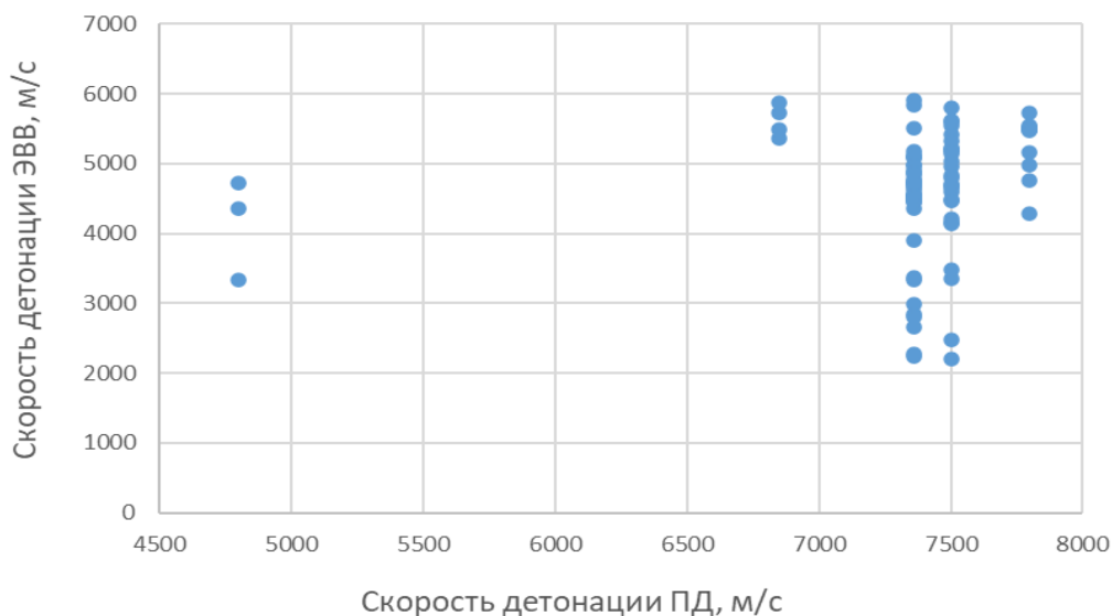
Рис. 2. Соотношение скоростей детонации зарядов ВВ и ПД, инициирующих эти заряды (взяты максимальные номинальные значения скорости детонации ПД из табл. 2)
