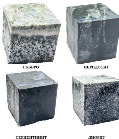
Рис. 2. Образцы вскрышных горных пород карьера АО «Ураласбест», подготовленные для испытаний
