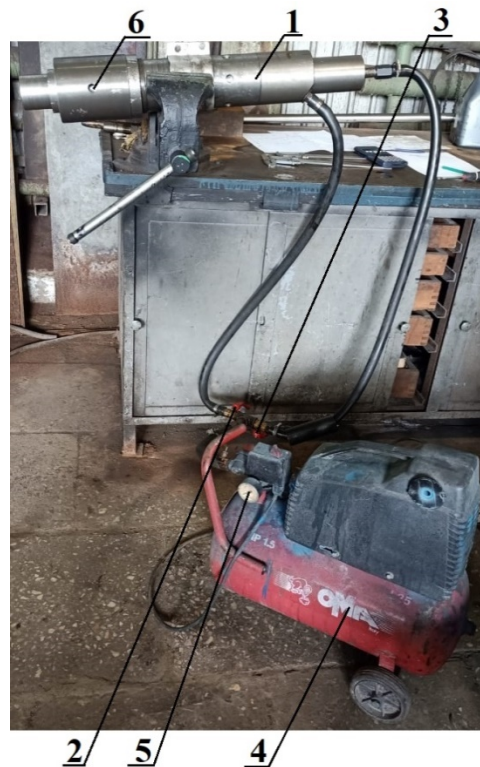
Рис. 2. Общий вид стенда для испытания клапанов: 1 – машина; 2 – кран подачи давления в камеру рабочего хода; 3 – кран подачи давления в камеру холостого хода; 4 – компрессор; 5 – манометр; 6 – выхлопное отверстие
