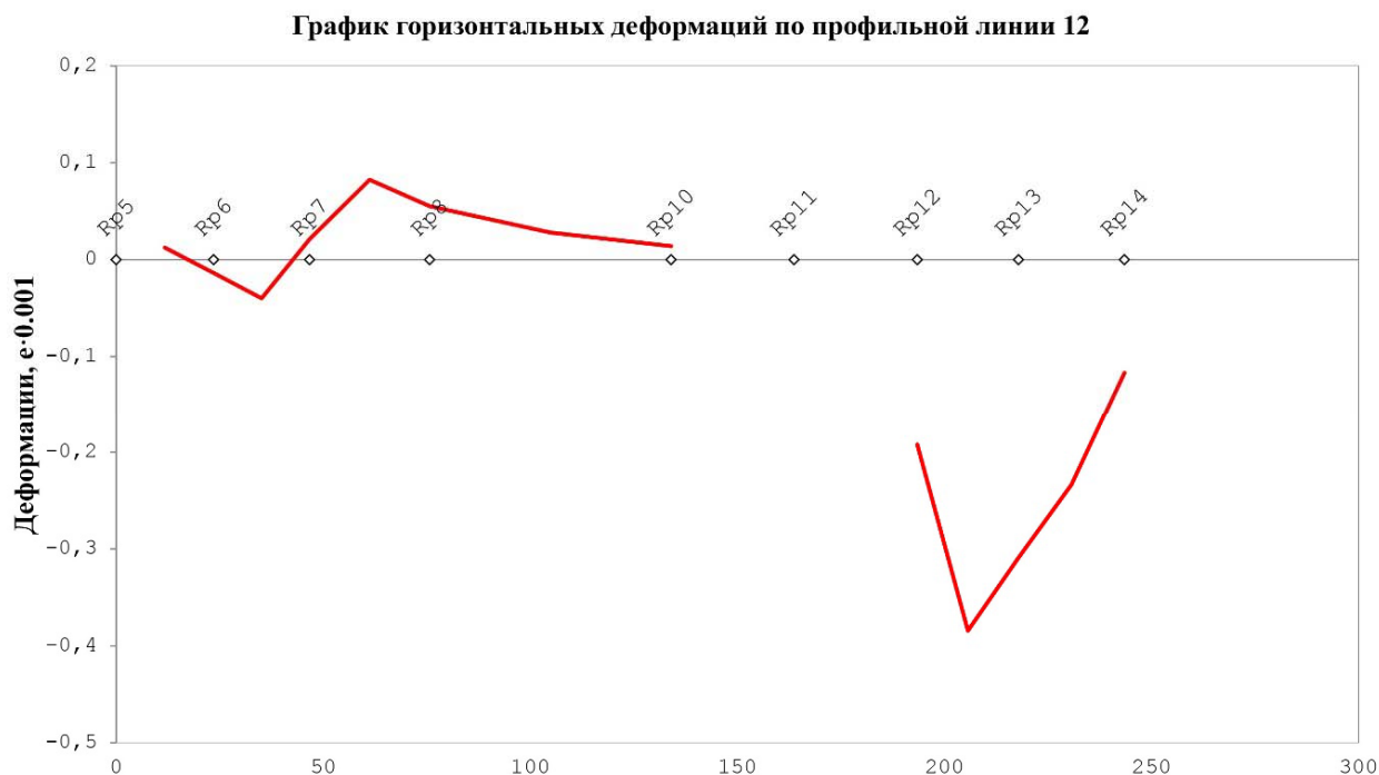
Рис. 4. График горизонтальных деформаций по профильной геодезической линии 12 за период 8 месяцев. Участок промплощадки ш. Северопесчанская, г. Краснотурьинск Свердловской области, 2023 г.
