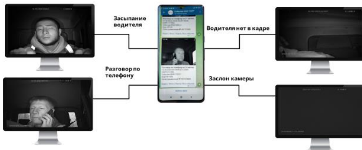
Рис. 4. Причины формирования автоматического сообщения диспетчеру в системе мониторинга физического состояния водителей
