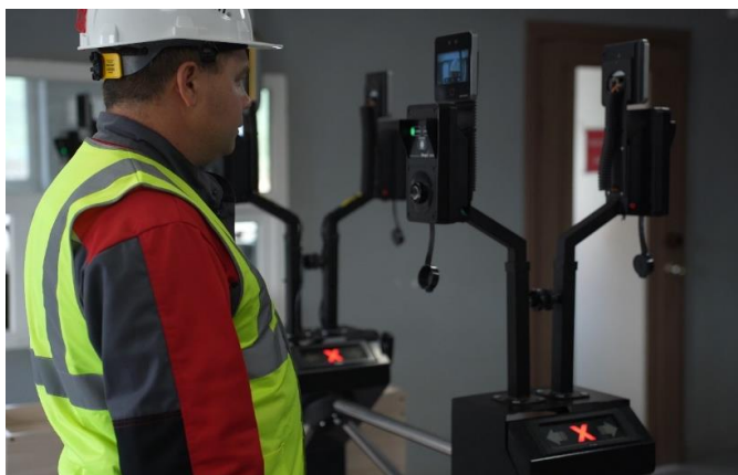
Рис. 1. Алкотестер, установленный на входе в технопарк Солнцевского угольного разреза
