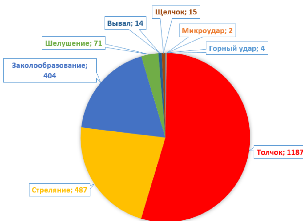
Рис. 2. Виды динамических проявлений горного давления на месторождении Южное с указанием их количества в период 1986 – 2023 гг.
