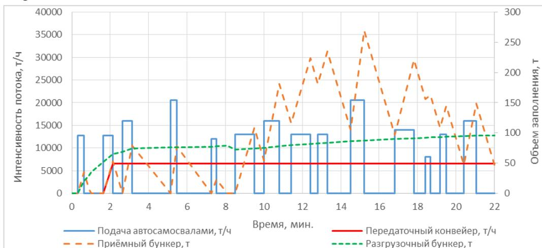
Рис. 2. Изменение интенсивности рудопотока и объема заполнения бункеров во времени при работе дробильно-перегрузочной установки
