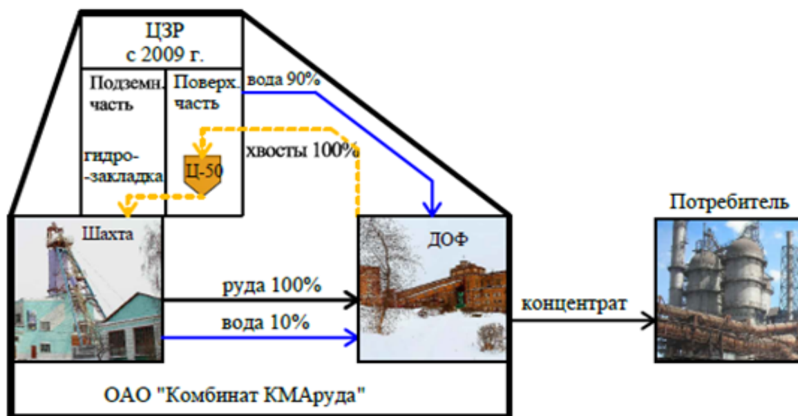
Рис. 4 – Технологическая схема утилизации хвостов обогащения в выработанном пространстве подземного рудника с замкнутым водоснабжением горного предприятия (ОАО «Комбинат КМАруда»)
