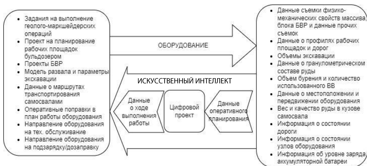
Рис. 3. Схема процесса оптимизации подачи руды на обогащение на цифровом горнодобывающем предприятии
