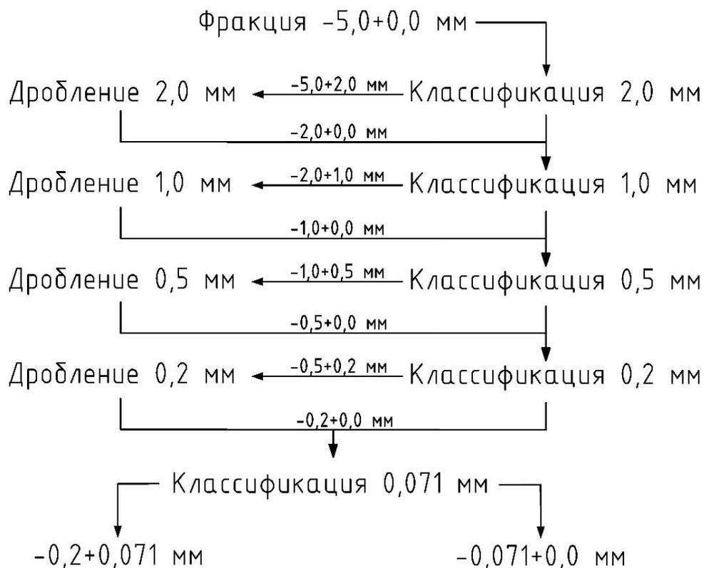
Рис. 6. Схема стадийного дробления оловянной руды класса  $-5,0+0,0$
